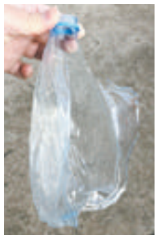
▲矿泉水瓶先是变成橄榄球形,随后炸裂。
