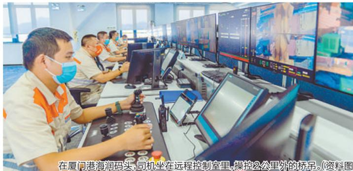
在厦门港海润码头,司机坐在远程控制室里,操控2公里外的桥吊。(资料图)
