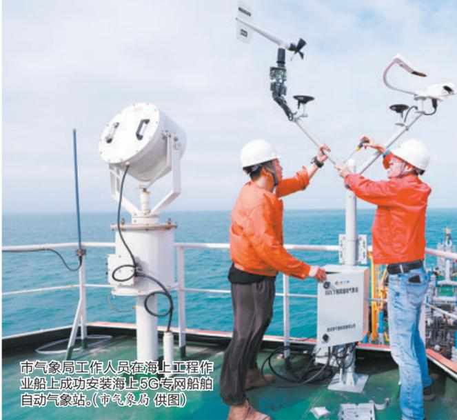
市气象局工作人员在海上工程作业船上成功安装海上5G专网船舶自动气象站。(市气象局 供图)
