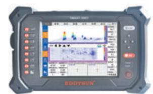
▲基于电磁涡流检测技术的重大装备关键部件检测系统
