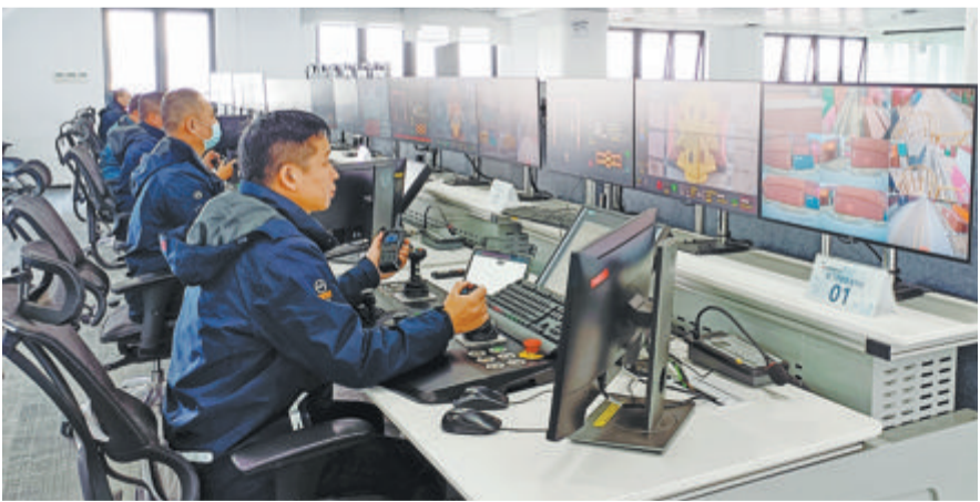
▲张增华通过操控台远程指挥龙门吊装卸集装箱。(海润码头 供图)
