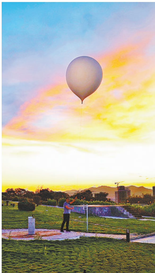
▲气象工作人员放飞高空探测气球,采集不同高度的气象数据。
