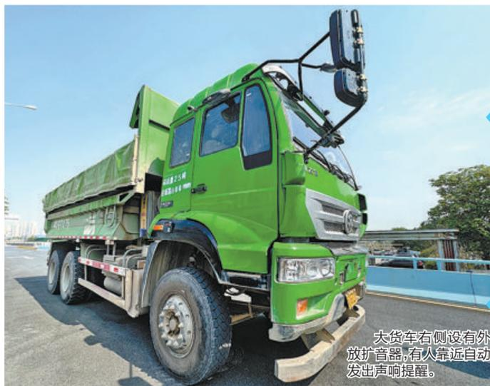
大货车右侧设有外放扩音器,有人靠近自动发出声响提醒。
