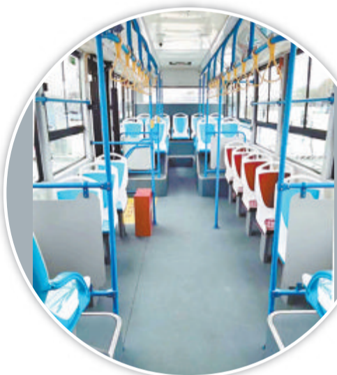
▲采用轮边驱动桥的低地板纯电动公交车,只需一级踏步即可上下车,车内通道平坦。
