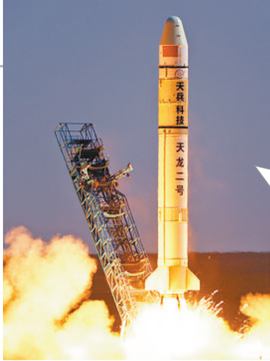
天龙二号运载火箭由民营航天企业北京天兵科技有限公司研制,是国内首枚民营液氧煤油火箭。火箭采用“三平”测发模式,即水平总装、水平测试、水平转运,对发射区地面设施、道路运输、车辆运输等要求较低,具备良好的经济实用性。文/据中新网 图/新华社发
