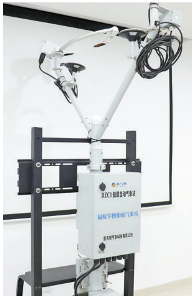
即将安装在集装箱船舶上的自动气象站。(厦门港务 供图)
