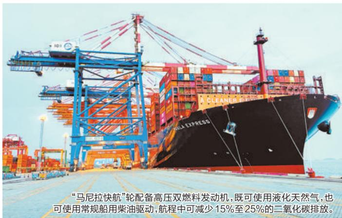
“马尼拉快航”轮配备高压双燃料发动机，既可使用液化天然气，也可使用常规船用柴油驱动，航程中可减少15%至25%的二氧化碳排放。
