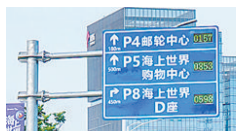
停车智能引导屏能实时更新显示停车场余位信息，引导车辆就近停放。
