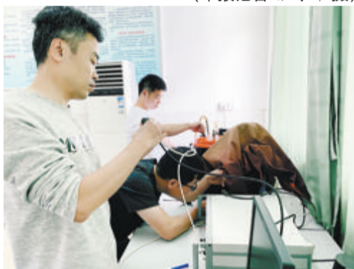
厦门市地震局工作人员开展水氧仪器标定检查。
