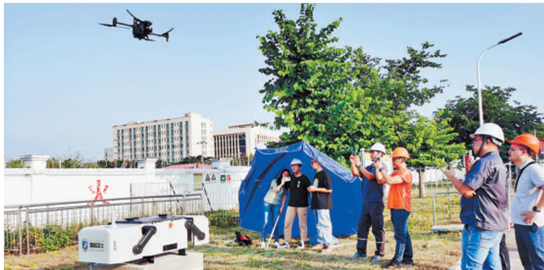
燃气巡检无人机从智能机库起飞作业。(厦门华润燃气供图)
