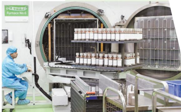
▲施耐德车间内回收再利用的6号真空焊炉。
