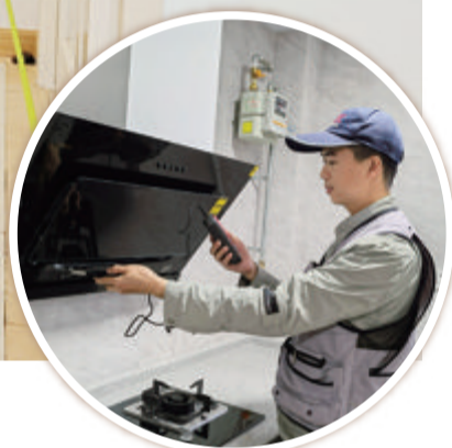
▼ 验房师测量排油烟机的排风风速。(受访者供图)
