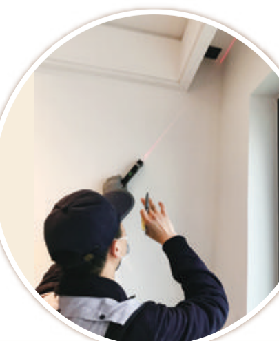
◀ 验房师用内外直角检测尺测水平度。
