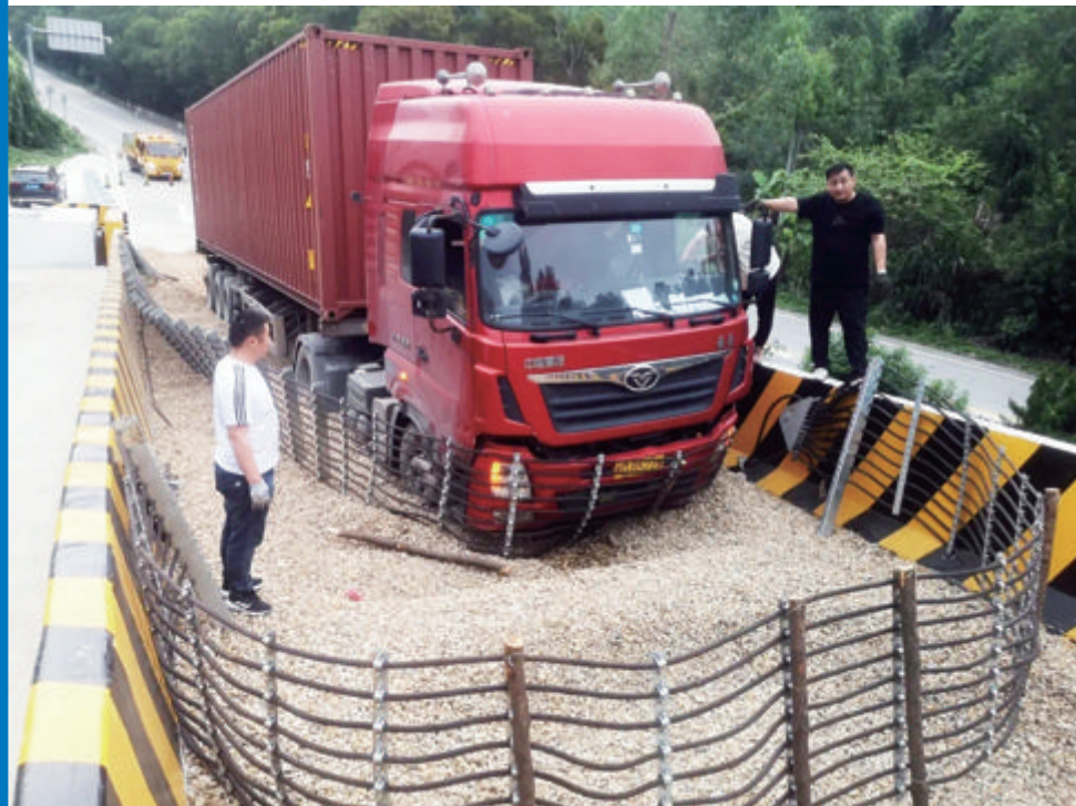
道路紧急停车处网索拦截系统成功将失控车辆拦停。
