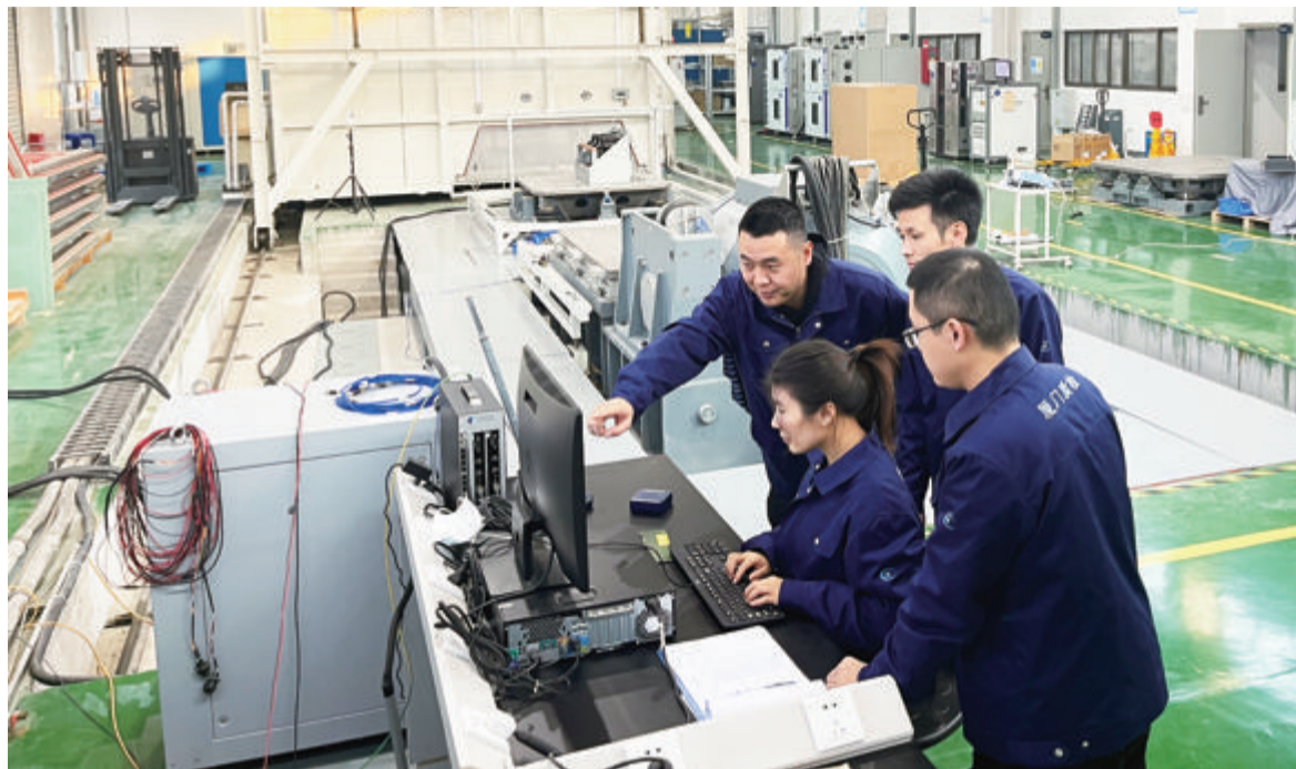
市质检院组织技术专家对锂离子电池包进行振动测试,研究电池包机械性能。
