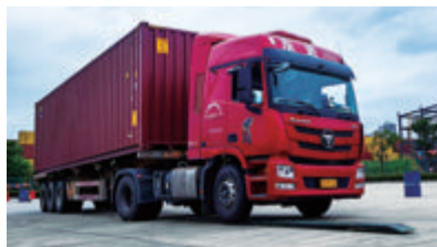
集装箱车正在过单边桥。
